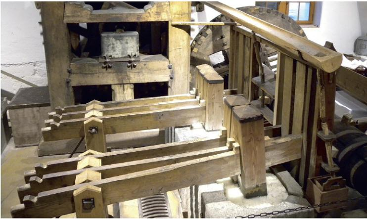
Lärmige Tonkulisse hinter der Letzimauer. In Basels erstem Industriequartier schlagen die mit Mühlrädern betriebenen Stampfhämmer Stoffsetzen in Wassertrögen zu Papierbrei.
