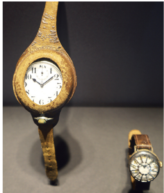
Uhren für Soldaten in den Schützengräben des ersten Weltkriegs, mit Schutzdeckeln und Gittern über dem Zifferblatt
