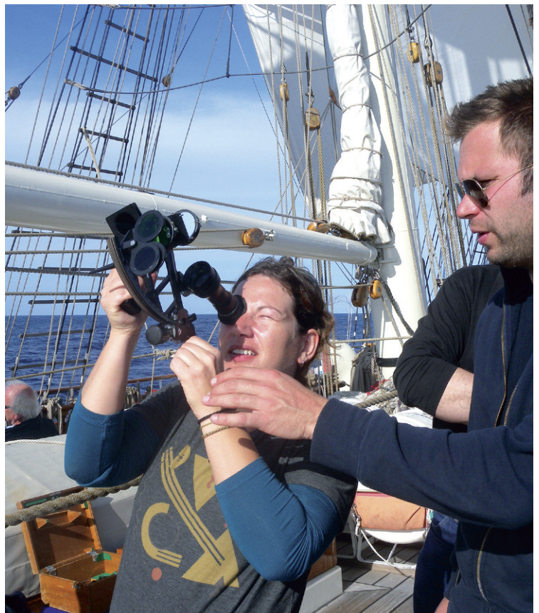
Instruktion an Bord eines Grossseglers: Bestimmen des Längen- und Breitengrads mit Sextant und Uhr. Jedes Schiff auf See muss heute mit zwei unabhängig voneinander funktionierenden Ortsbestimmungssystemen fahren, also neben dem GPS auch mit Sextant, Chronometer und mit dem jährlich neu aufgelegten "Nautical Almanach", der die Sonnen- und Sternenkonstellationen angibt.
