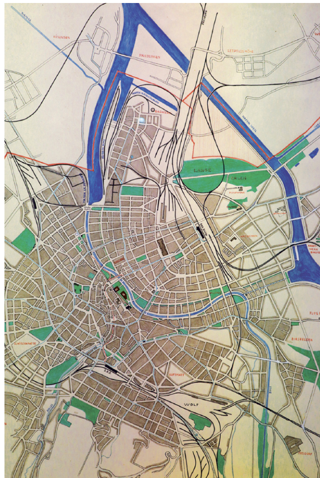
Im Rausch des Machbaren: die Umleitung des Rheins in einen Kanal im Norden, damit so im Stadtzentrum mehr Platz gewonnen werden kann. Projektidee von Franz und Paul Wilde aus dem Jahr 1932.
