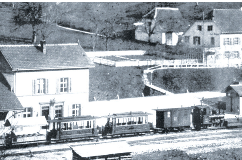
Ab 1880 verkehrte die 75 cm-Schmalspurbahn von Liestal nach Waldenburg. Im Bild von 1881 ist ein Zug mit der ersten Lokomotive "Dr.Bider" zu sehen.
