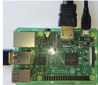
Raspberry Pi (kurz: 'Raspi') ist ein Allzweck-Computer, normalerweise mit Linux Betriebssystem, und kann gleichzeitig mehrere Programme ausführen. Er ist in der Benutzung etwas komplizierter als ein Arduino.
