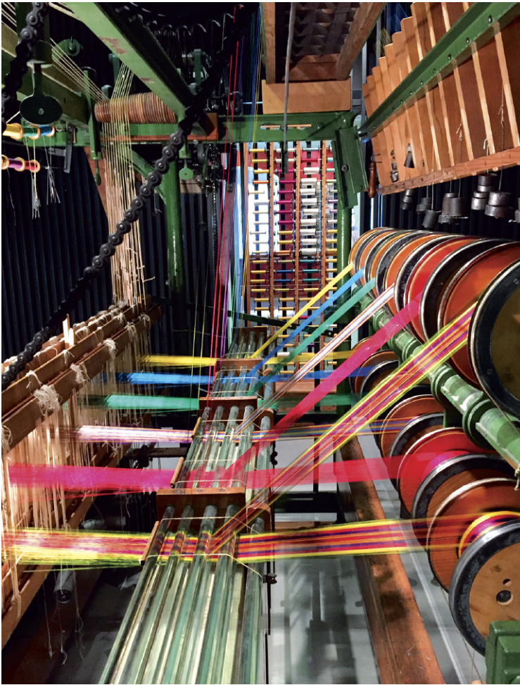
Kantonsmuseum Baselland in Liestal. Links der so genannte Sägerstuhl, ein lochkartengesteuerter Webstuhl für Seidenbänder. Betrieb des Webstuhls jeden ersten Sonntag im Monat, jeweils von 14 bis 17 Uhr. Rechts Muster von Seidenbändern – Exportschlager aus dem 18., 19. und 20. Jahrhundert.
